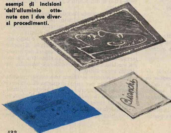
Fig. 4 - Il procedimento di incisione dell'alluminio si rende assai utile per comporre piccoli quadranti o scale numeriche da applicare su pannelli di apparati elettrici.
